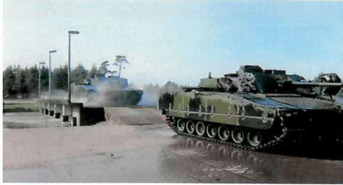
2 pav. Transporto priemonių dugno plovimo estakados pavyzdys
